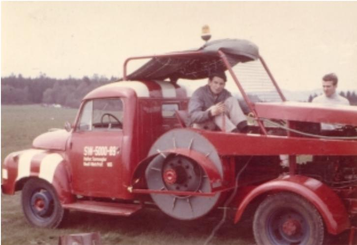
eines schweren Schulungs- und Leistungsdoppelsitzers vom Typ Ka 7 plante, für den die Schlepplleistung des alten Horch nicht mehr ausreichen würde, mußte dieser durch ein stärkeres Modell ersetzt werden. Die Lösung war ein 4,2 l V8 Motor von Chevrolet mit über 200 PS. Das komplette Windenaggregat wurde auf einen Hanomag L 28 montiert, gestiftet von dem älteren Herrn, der am Doppelraab nicht mal seinen Rock
